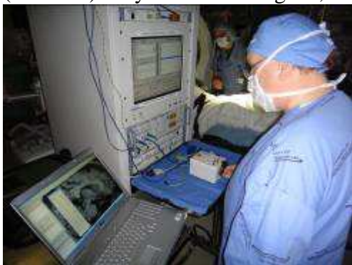
1c) rechts: Axon Instruments Turm zur Einzelzelleableitung; links: Laptop mit OneTrack zur simultanen 3D-Rekonstruktion der electrophysiologischen Befunde; Vordergrund: Klaus Mewes, PhD am Microdrive
